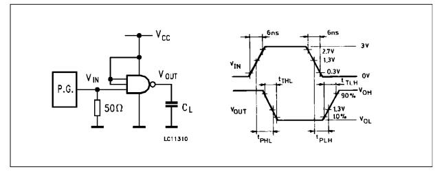
TEST CIRCUIT Icc (Opr.)
